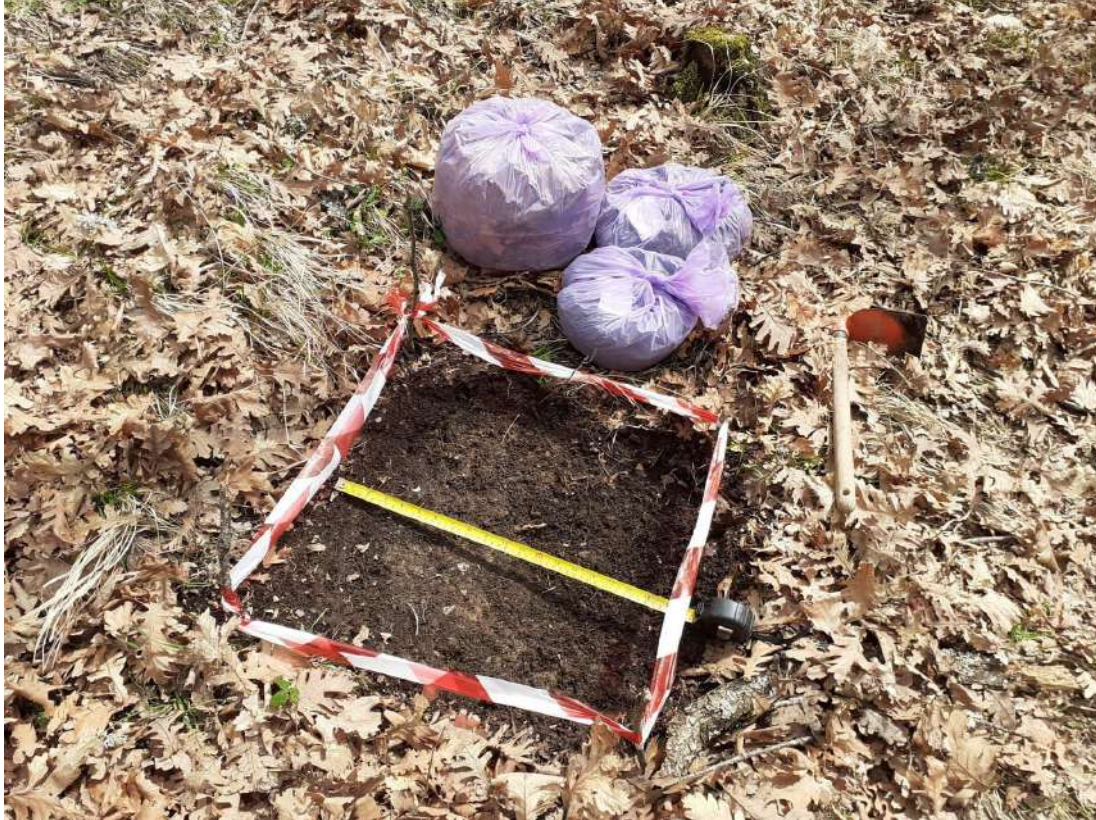
Εικόνα 14,15 και 16: Δειγματοληψίας της δασικής φυλλάδας για τον προσδιορισμό της συσσώρευσης άνθρακα στο δασικό τάπητα.
